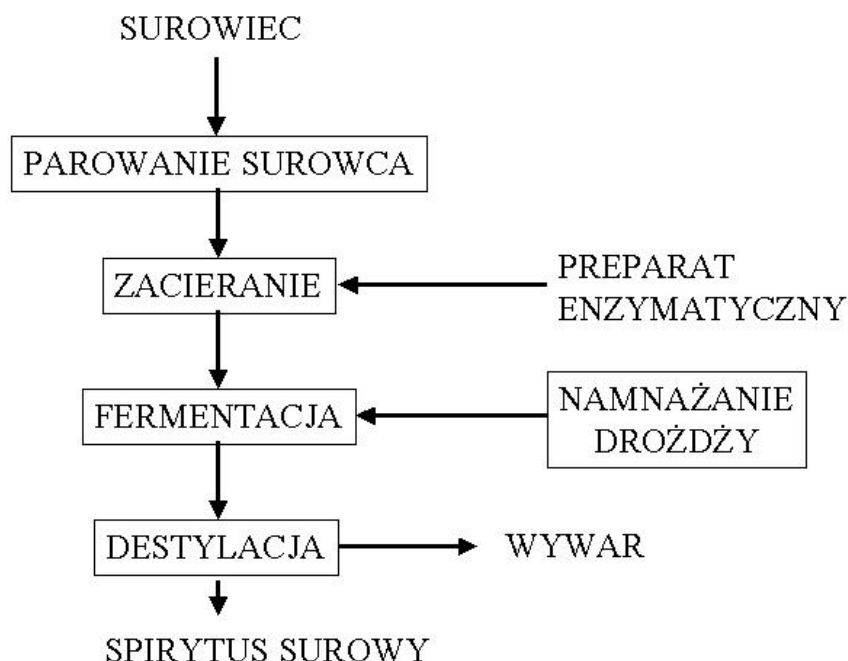
Rysunek 1. Schemat otrzymywania alkoholu w gorzelnii zbożowej
