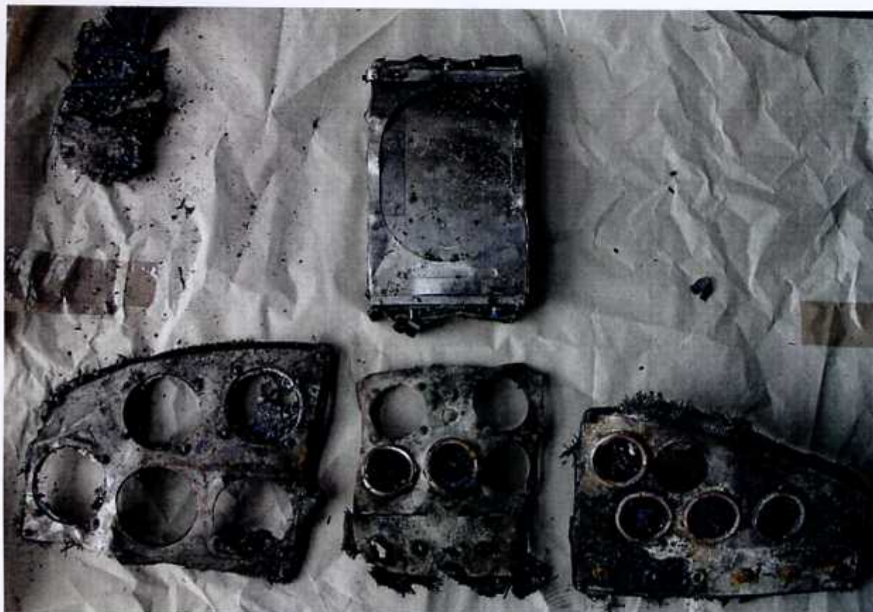
13 – Zniszczone pożarem tablice przyrządów i radiostacja.
