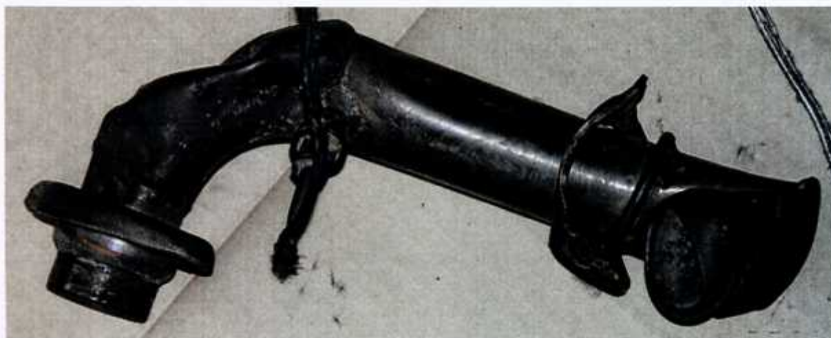
23 – Wylot spalin z cylindra z zamontowanym czujnikiem temperatury gazów wylotowych..
