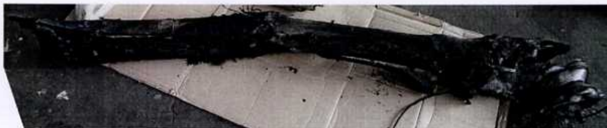
32 – Spalona goleń podwozia głównego i piasta lewego koła głównego.
