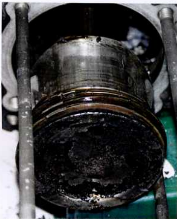
43 – Jeden z tłoków przed demontażem.
