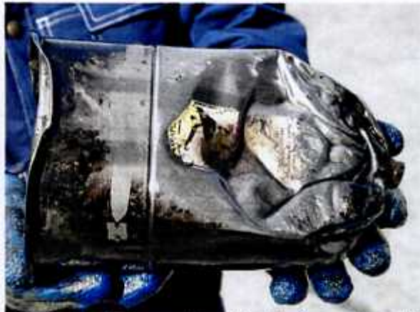
19 i 20 – Uszkodzony zbiornik oleju (bez pokrywy) i jego wnętrze.
