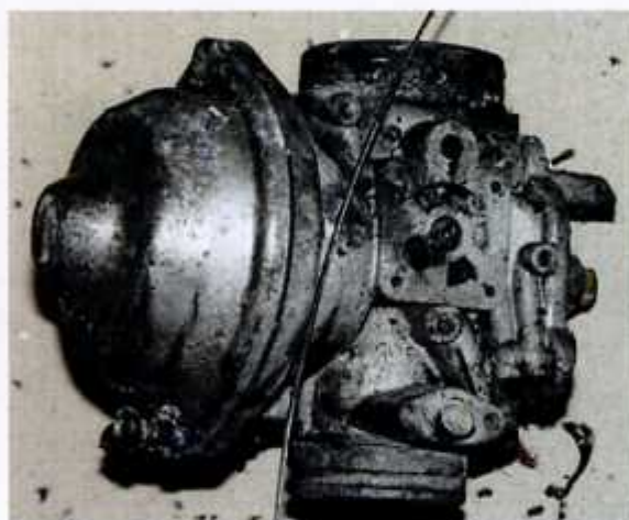
54 – Wnętrze pompy paliwowej silnika po jej zdemontowaniu i odcięciu pokrywki.
