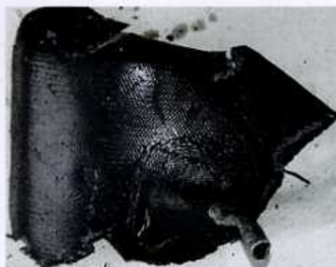
29 – Górny fragment płaszcza zbiornika paliwowego z wyprowadzeniem przewodu odpowietrzenia.
