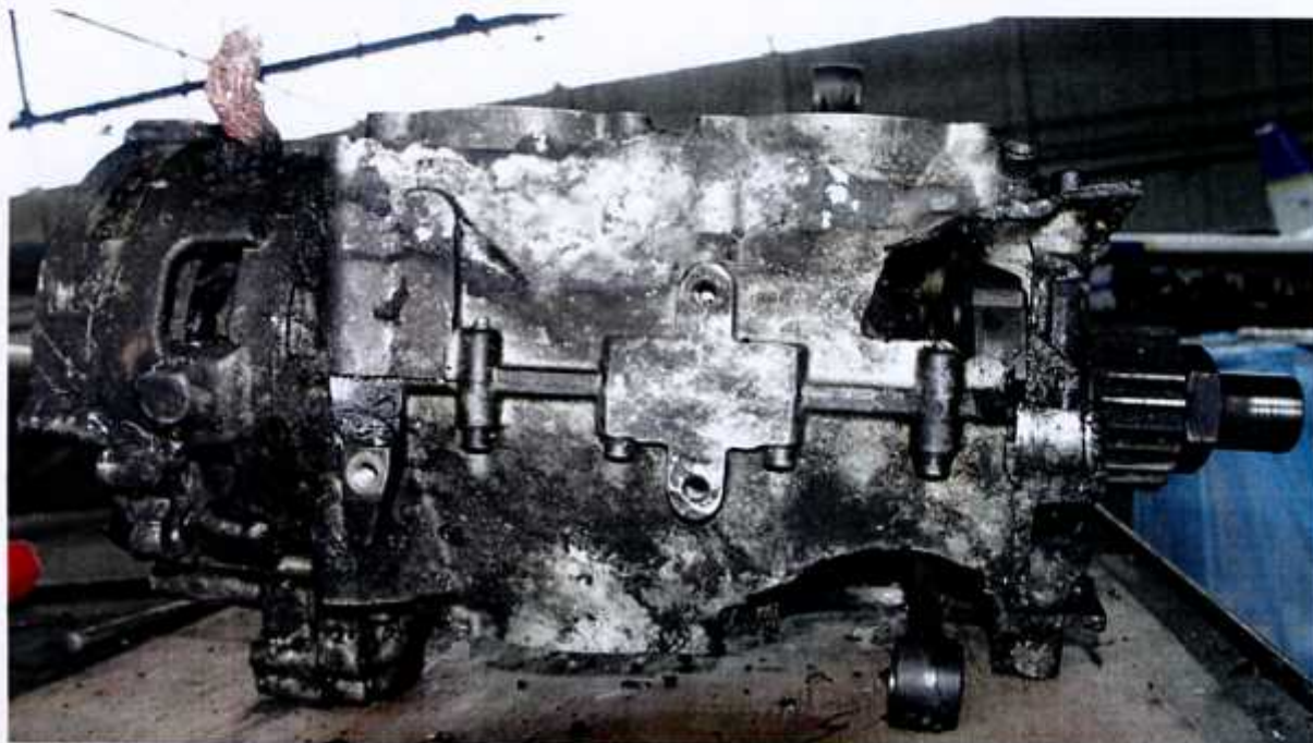
45 – Korpus silnika od spodu – po prawej widoczne miejsca odłamania jednego z cylindrów i reduktora.
