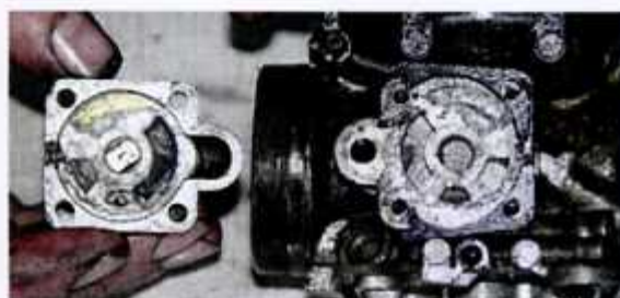
59 i 60 – Gaźniki – zdjęte sterowanie poprawką wysokości.
