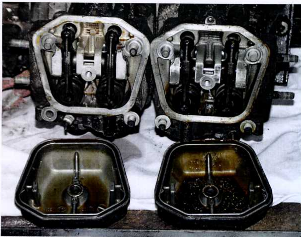
50 – Głowice mniej uszkodzonych cylindrów po zdjęciu osłon.
