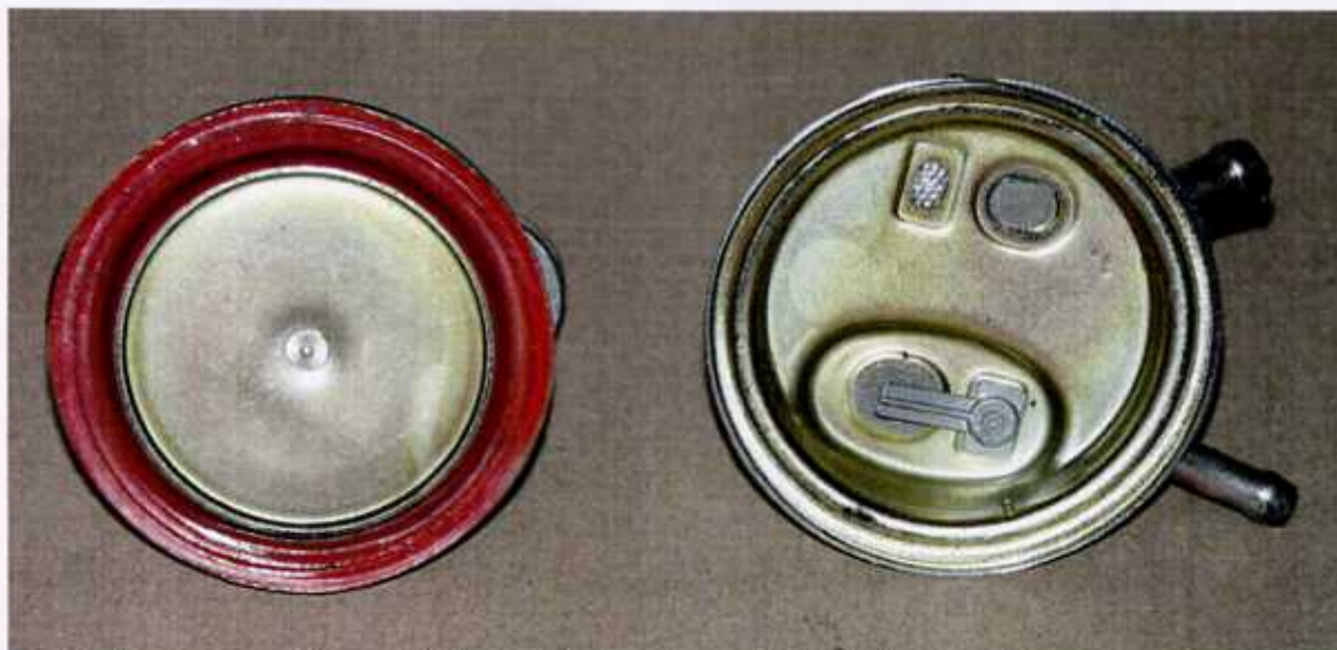
54 – Wnętrze pompy paliwowej silnika po jej zdemontowaniu i odcięciu pokrywki.
