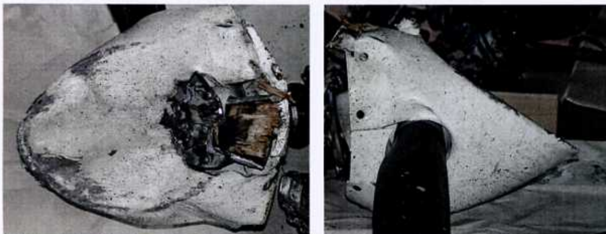
33 i 34 – Kołpak śmigła z piastą i jedną nie oderwaną łopata. Na zdjęciu 29 wyraźnie widać spłaszczenie kołpaka, odtwarzające położenie płaszczyzny podłoża względem osi silnika w chwili zderzenia z ziemią.
