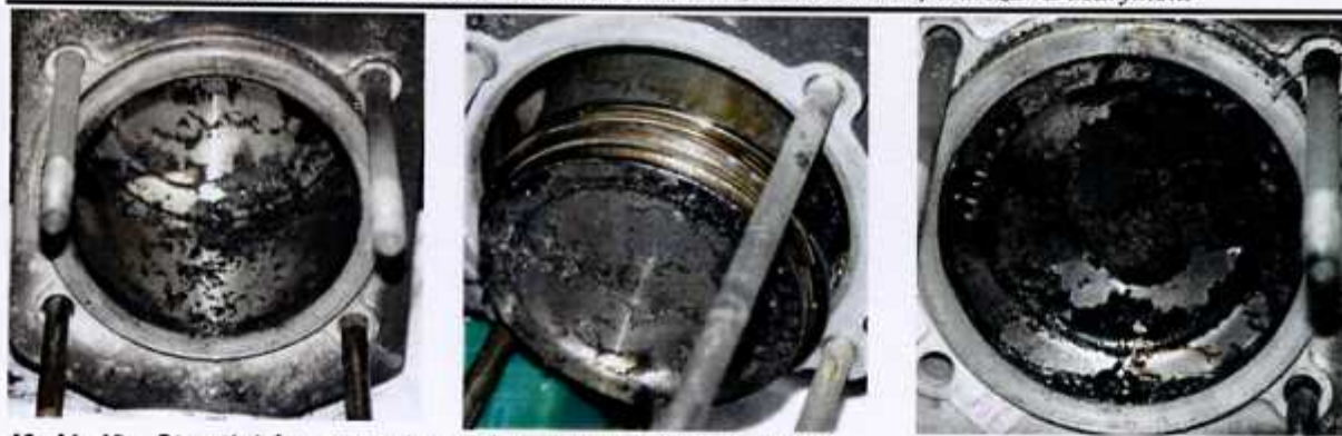
40, 41, 42 – Stan tłoków w trzech mniej uszkodzonych cylindrach.
