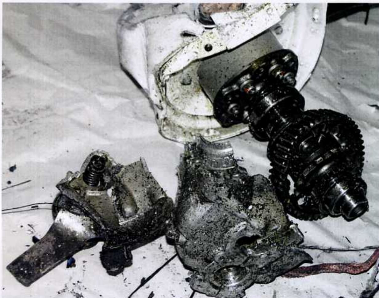
24 i 25 – Zniszczony reduktor silnika i piasta śmigła.
