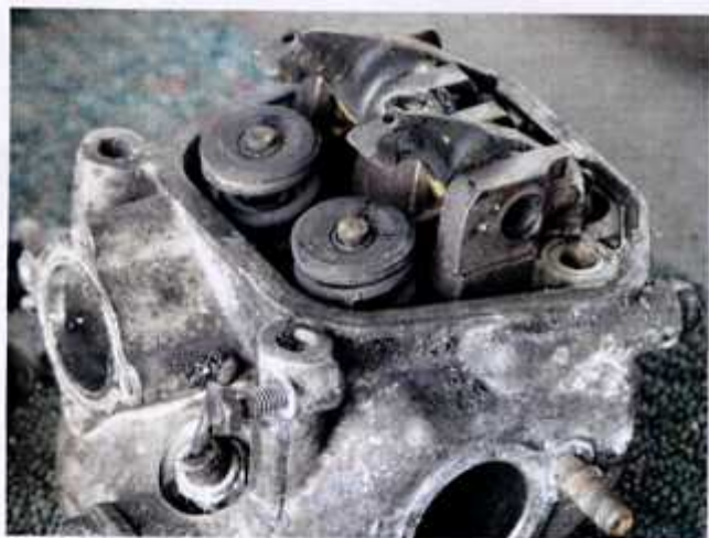
48 i 49 – Głowice bardziej uszkodzonych cylindrów bez osłon.
