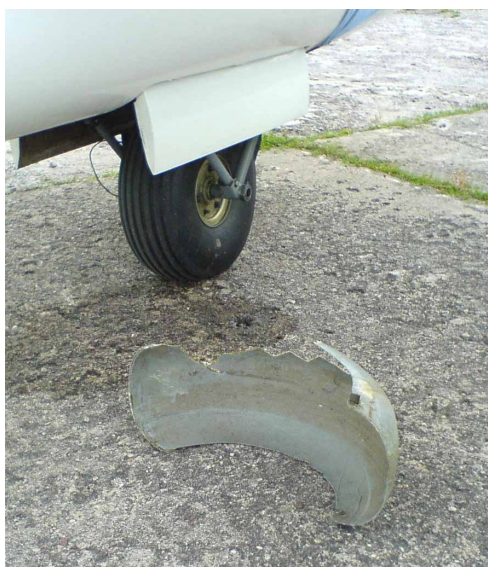
11 i 12 – Uszkodzenia błotnika koła.
