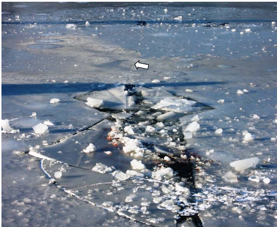
Fot. 11 – Dziura w lodzie od podwozia przedniego i łopaty śmigła; widoczna, oznaczona strzałką, rysa na lodzie od elementu podkadłubowego (patrz również szkic – załącznik Z2).
