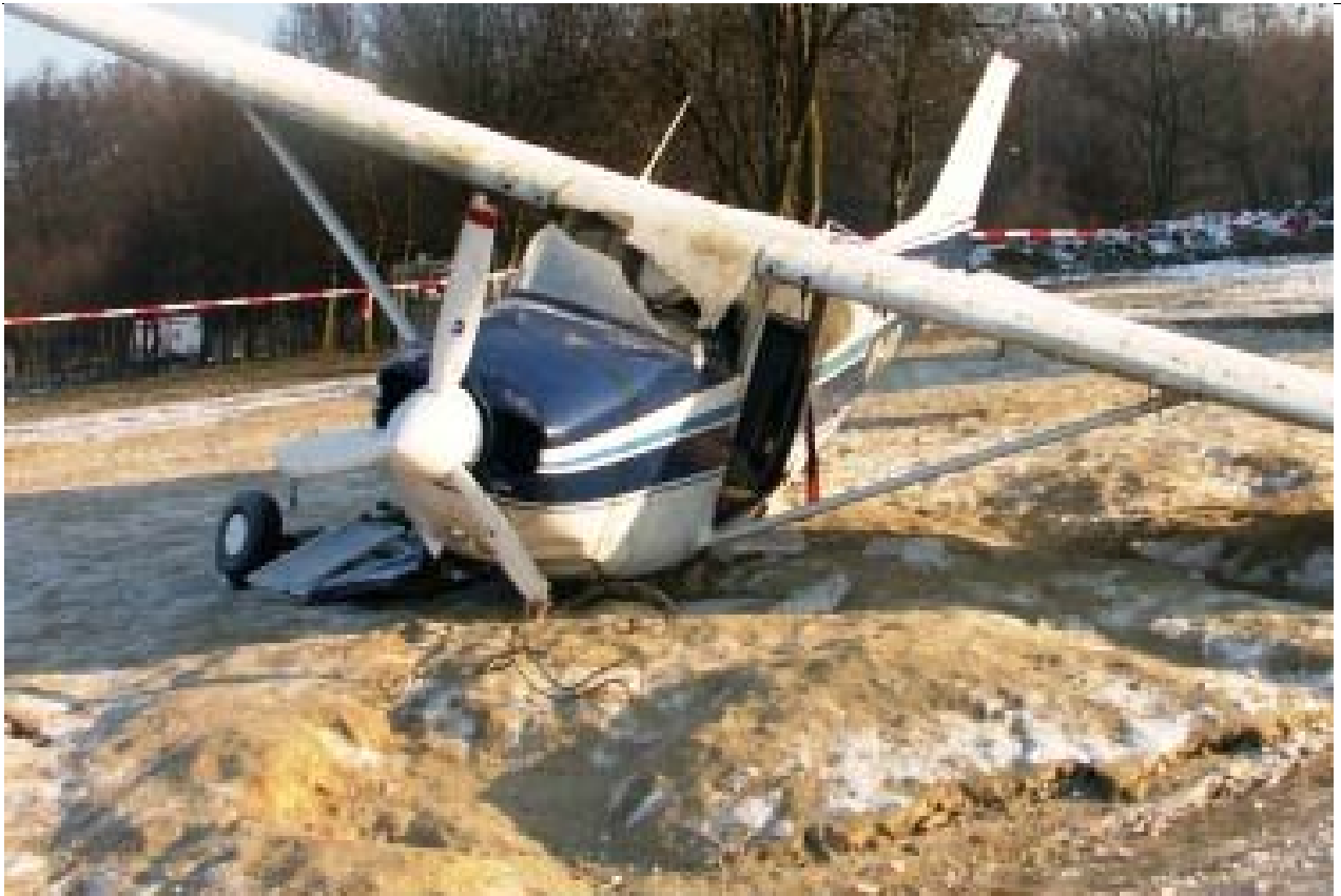
Fot. 8 – Uszkodzenia śmigła (ułamane wszystkie łopaty) świadczą o tym, że śmigło obracało się przy uderzeniu samolotu o lód, tzn. w silniku był olej.
