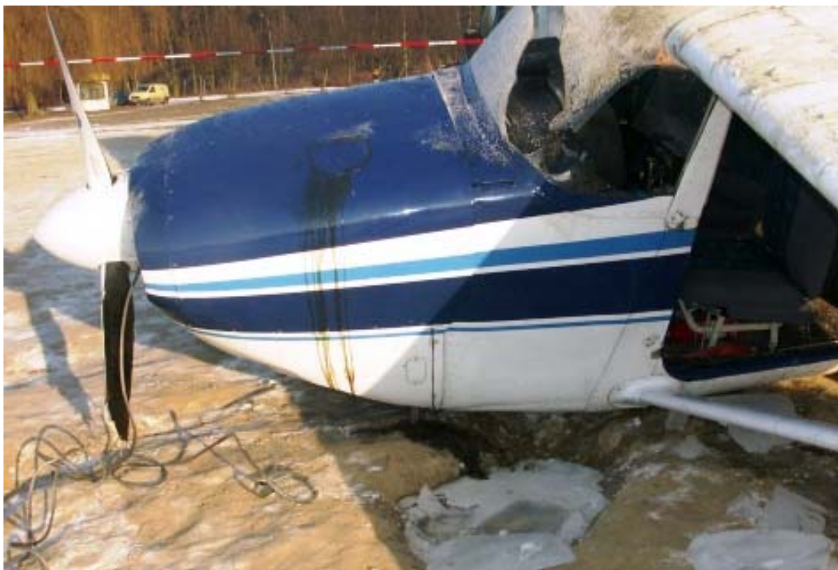
Fot. 6 – Olej z silnika zgromadzony pod osłonami silnika wypchnięty przez wodę szczelinami wziernika oleju spłynął po osłonach po wydobyciu samolotu z wody; widoczny olej na szybie przedniej dostał się tam z wody.
