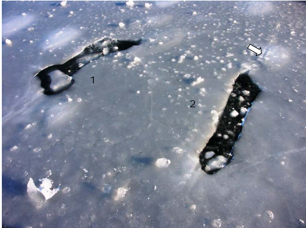
Fot. 10 – Dziury w lodzie: 1 – od podwozia lewego głównego, 2 – od elementu podkadłubowego; widoczna, oznaczona strzałką, rysa na lodzie od elementu podkadłubowego (patrz również szkic – załącznik Z2).
