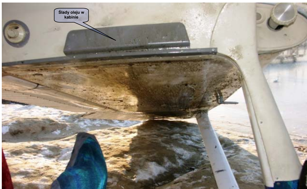
Fot. 7 – Widok na górę lewej strony kabiny z widocznymi śladami oleju.
