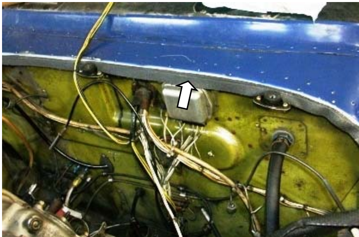
Fot. 9 a i b – Strzałki wskazują miejsce uszczelnienia górnych osłon (odcisk kątownika osłon); zdjęcia pokazują, że tą drogą olej nie mógł wydostać się na szybę ja to widać np. na fot. 6 i 8, co oznacza, że olej na szybę dostał się z wody.
